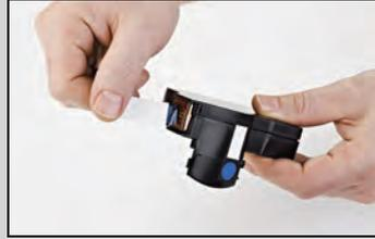
Entfernen Sie die Schutzstreifen vom Druckkopf der Farbkartusche.
