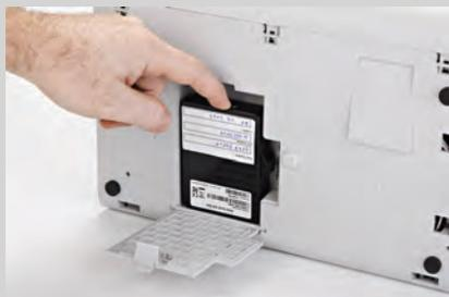
Führen Sie das PSD in das Frankiersystem ein, indem Sie es vertikal mit den Kontakten nach unten und hinten positionieren, wobei die Etiketten zu Ihnen zeigen. Schließen Sie die Abdeckung für das PSD.
