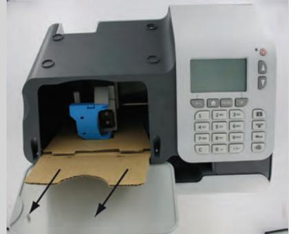
Entfernen Sie die Transportsicherung, um den ungehinderten Betrieb des Systems zu ermöglichen.
