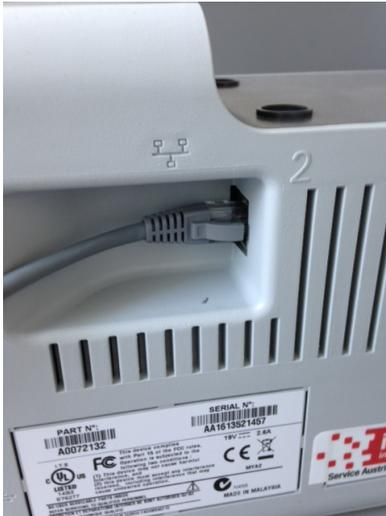
Stecken Sie das LAN Kabel in die Frankiermaschine (Pos.2).
