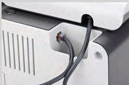
Schließen Sie das Kabel der Wiegeplattform an das Frankiersystem an.
