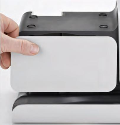
Öffnen Sie die vordere Abdeckung des Systems, indem Sie sie an der linken oberen Ecke leicht nach rechts drücken und zu sich heranziehen.
